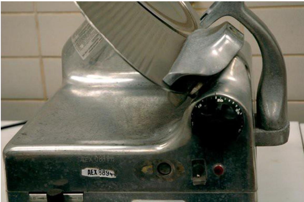
带有尘垢以及刀片下带有黑色残渣的切片机刀片。刀片可能受到 Lm 的污染， Lm 可能传播到刀片所切的产品上。切片机的手柄、控制装置和密封也可能受到污染，因为可能不会经常清洗这些区域。
