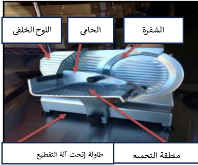
الشكل ٢ - الأماكن الموجودة على آلات التقطيع التي يصعب تنظيفها
